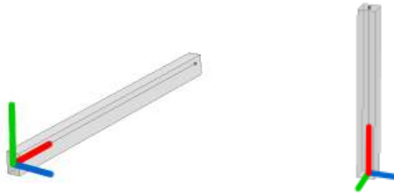
Terne locali dell'elemento asta (trave e pilastro)
